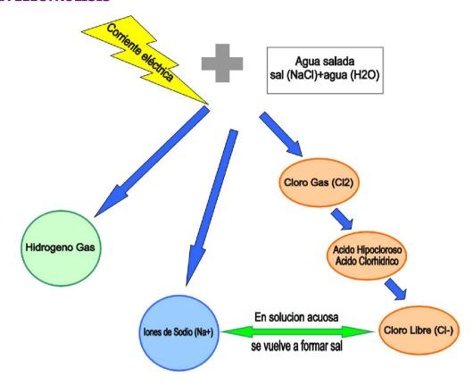
**Productos en el ánodo:** Cloro gas, a partir del cual se forma ácido hipocloroso (que actúa como desinfectante) y ácido clorhídrico
